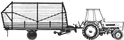
ein Schneidwerk mit 4 feststehenden Messern. Direktzug, daher hohe Stabilität, lange Lebensdauer, hohe Hangsicherheit und Beweglichkeit durch beidseitig gleichen Einschlag. Der ideale Ladewagen für kleine und mittelgrosse Betriebe.
