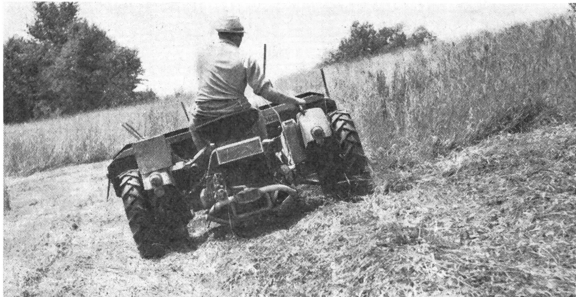
Abb. 3: Der sogenannte «Motormähwender» hier mit Doppelbereifung ausgerüstet, beim Mähen mit einem fingerlosen Doppelmesser-Mähwerk...
