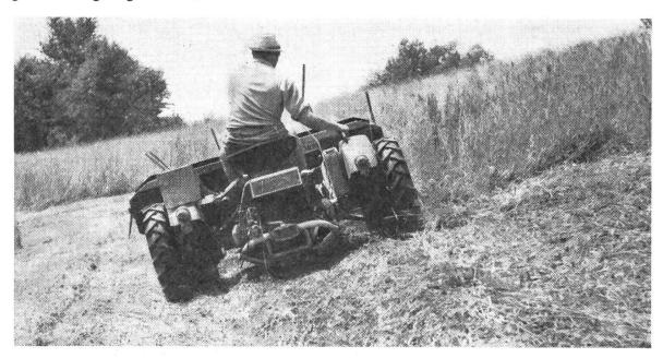
Abb. 3: Der sogenannte «Motormähwender» hier mit Doppelbereifung ausgerüstet, beim Mähen mit einem fingerlosen Doppelmesser-Mähwerk...
