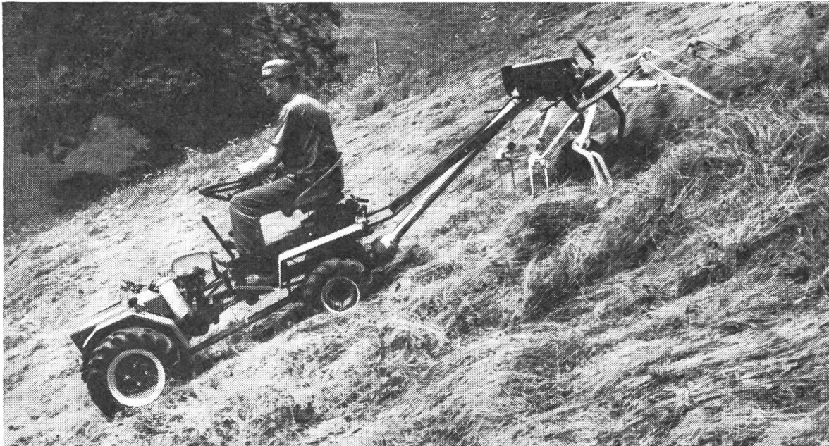
Abb. 9: Mit dem angehängten Kreiselheuer wird nur eine Arbeitsgrenze von 40–45 % erreicht.
