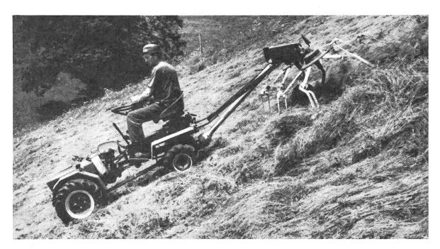
Abb. 9: Mit dem angehängten Kreiselheuer wird nur eine Arbeitsgrenze von 40-45 % erreicht.
