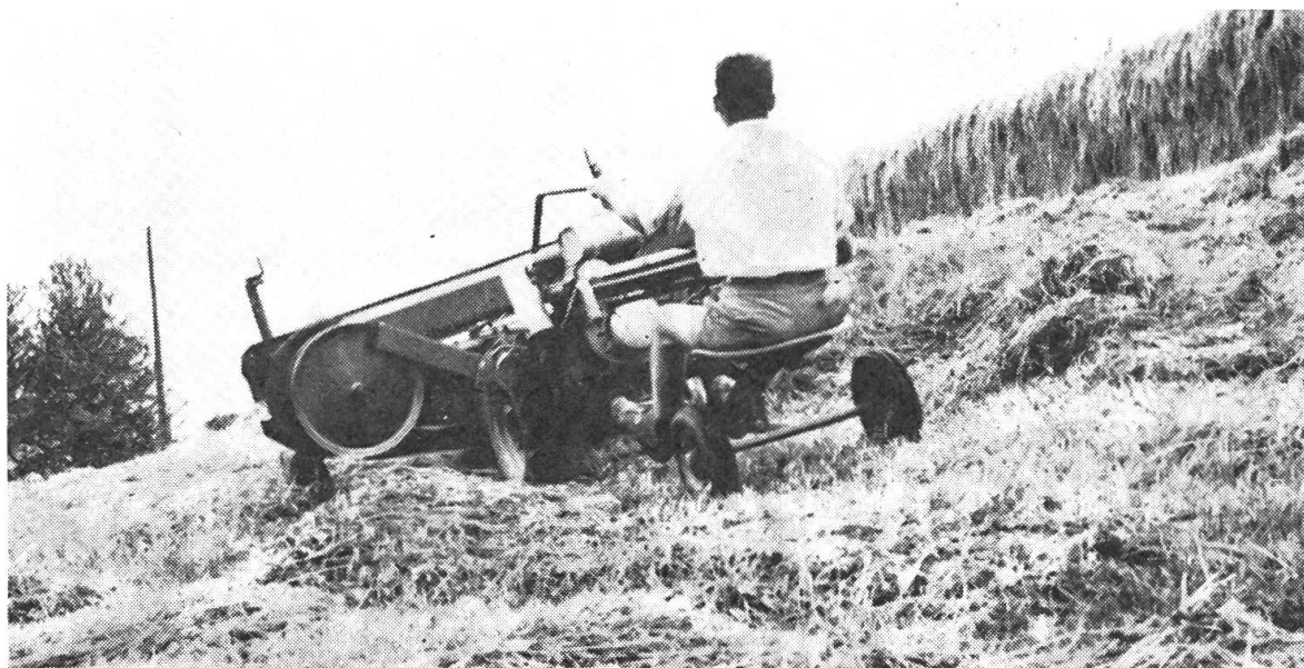
Abb. 2: Im leicht geneigten Gelände war hier der einfache Transportkarren durchaus verwendbar. Bei engen Kurven musste der Karren allerdings ausgehoben werden.
