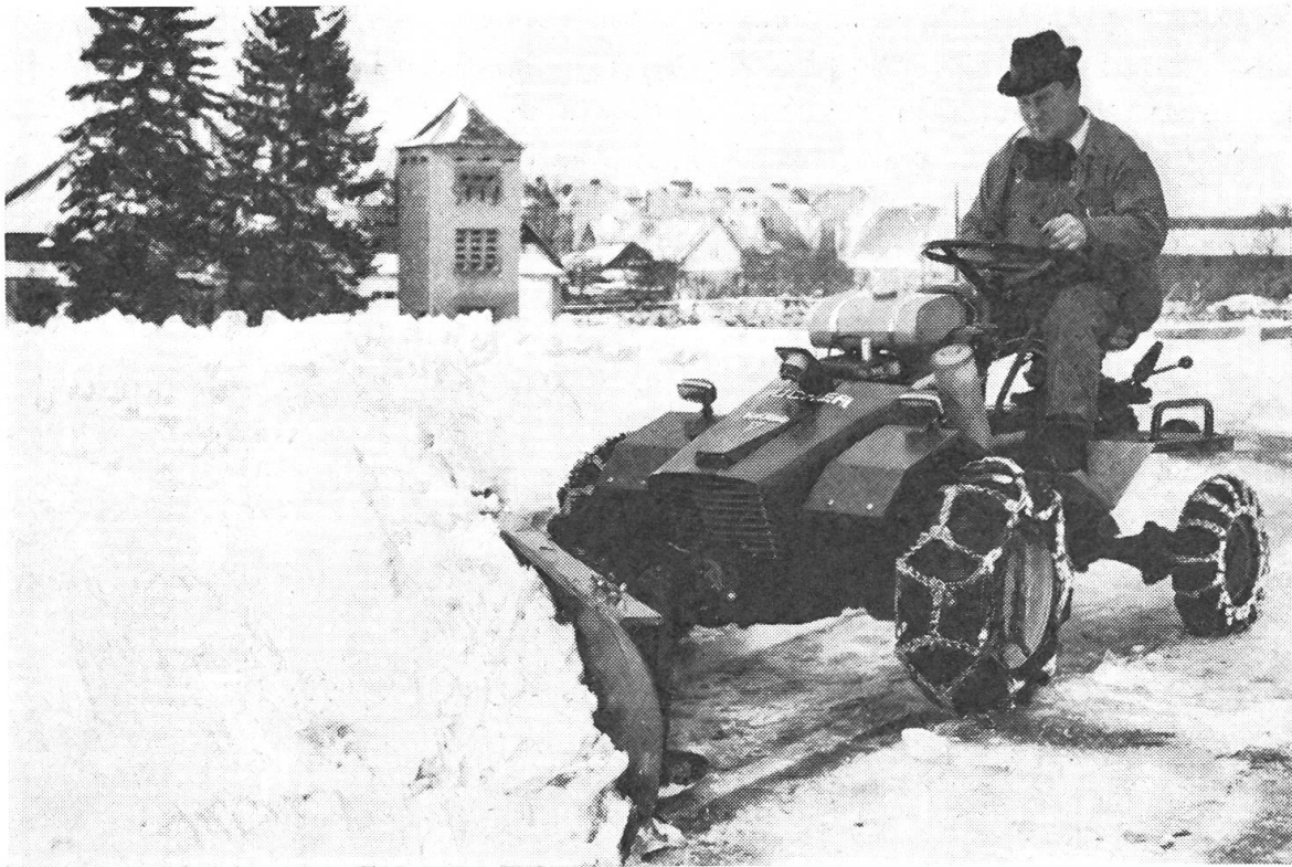
Abb. 10: Das Räumschild in Verbindung mit der sehr wendigen Maschine eignet sich besonders gut für die Schneeräumung von Höfen, Parkanlagen und Gehsteigen.
