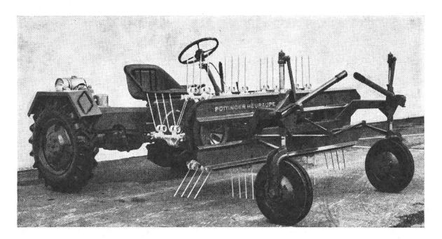
Abb. 12: Ein brandneues Gerät über welches zwar noch keine Erfahrungen vorliegen, das aber sicher sehr interessant ist: Ein selbstfahrender Heuer, mit welchem sitzenderweise gearbeitet werden kann. Wenn der angegebene Preis von S 37 00.— ca. Fr. 6000.—) zu halten ist, wäre die Maschine auch von dieser Warte interessant.
