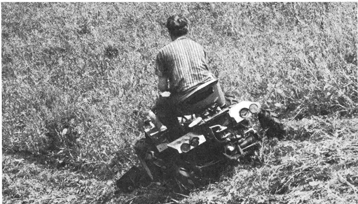
Abb. 5 und 6. Diese selbstfahrende Heuerntemaschine ist mit einem Frontmähwerk und ...
