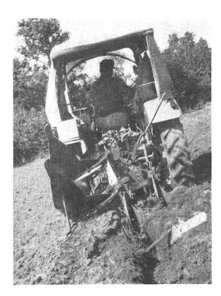
Abb. 2: Für die Hangackerung sind vor allem Winkelpflüge zu empfehlen.
