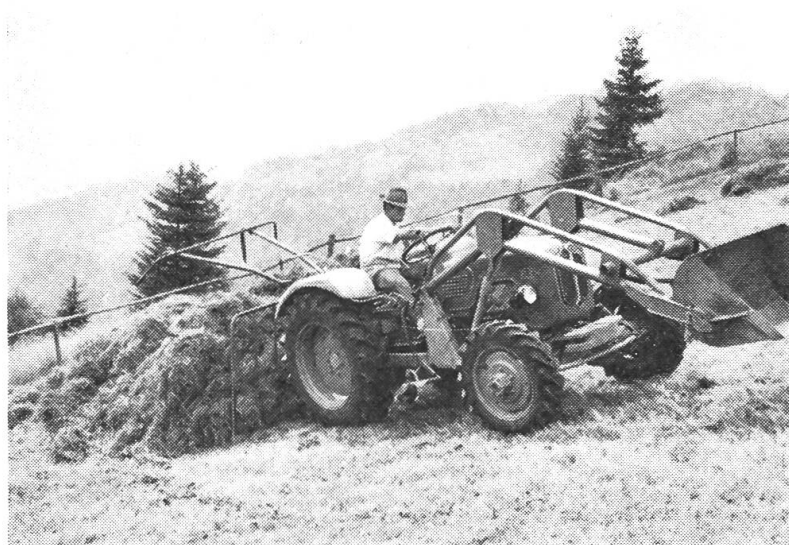
Abb. 9: Die Arbeit mit dem Heckschiebesammler am Hang erfordert meistens eine Zusatzbelastung der Vorderachse. Reicht das serienmässige Belastungsgewicht nicht, wird oft die Frontladerschwinge zu Hilfe genommen.
