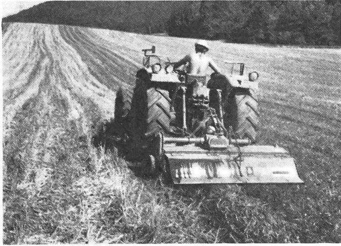
Abb. 2: Eine Spatenegge wie das Fabrikat «Rotavator» zerkleinert den Boden fein und mischt die Pflanzenreste gründlich ein.
