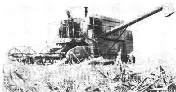
Für grosse und grösste Flächen wurde der Gross-Selbstfahrer Claas-Dominator 80 entwickelt. Seine Leistung entspricht höchsten Anforderungen und sein Bedienungskomfort erlaubt dem Fahrer, die Kapazität der Maschine voll zu nutzen. Die Verbesserung der Fahrtechnik durch den hydrostatischen Fahrantrieb (wahlweise gibt es auch mechanischen) führt zu einer beachtlichen Verringerung der Wende- und Verlustzeiten.
