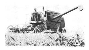
Für grosse und grösste Flächen wurde der Gross-Selbstfahrer Claas-Dominator 80 entwickelt. Seine Leistung entspricht höchsten Anforderungen und sein Bedienungskomfort erlaubt dem Fahrer, die Kapazität der Maschine voll zu nutzen. Die Verbesserung der Fahrtechnik durch den hydrostatischen Fahrantrieb (wahlweise gibt es auch mechanischen) führt zu einer beachtlichen Verringerung der Wende- und Verlustzeiten.
