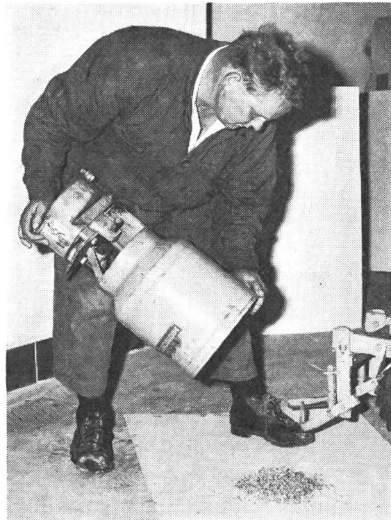
Abb. 3: Der Saatgutbehälter kann hier mit wenigen Griffen abgenommen und restlos entleert werden.
