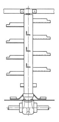
die Streuwalze dieser AGRAR-Mistzettmaschine mit andern. Vergleichen Sie auch deren Antrieb (bei der AGRAR-Mistzettmaschine ein gegen Verunreinigung dicht verschlossenes Ölbadgetriebe).
