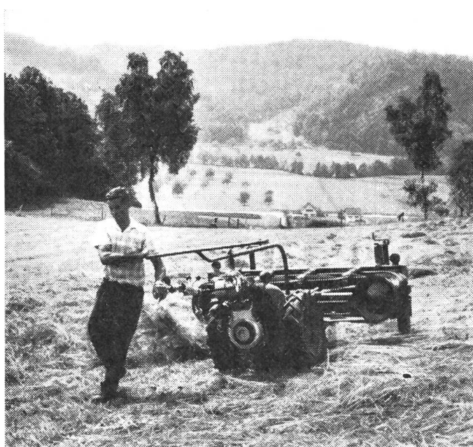
Eine relativ gute Hangtauglichkeit zeigen Bandrechen mit Stützradlenkung.
