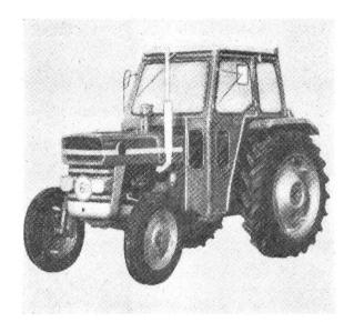
Abb. 3: Schutzkabine. Die tragenden Elemente bilden mit dem Umbau eine Einheit.
