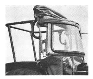
Abb. 2: Schutzrahmen mit montiertem Verdeck.
