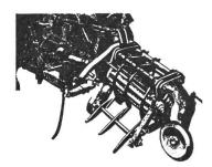
Lässt sich an jeden Traktor mit normalisierter 3-Punkt-Aufhängung anbauen, sowie an gewisse Sattelschlepper.
