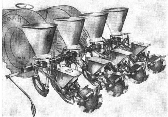
Mit dem «Muli 330» lassen sich mehrere Arbeitsgänge zusammenfassen: Saatbeetbereiten, Unterfussdüngung, Einzelkornablage, Band- oder Flächenspritzung.
