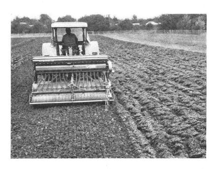
Abb. 6: Auf gepflügtem Acker erfolgt die Einsaat von Wintergetreide mit der Fräs-Drill-Kombination in einem Arbeitsgang.
