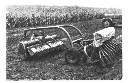
Abb. 2: Über einen Zusatzrahmen wird an eine Anbaufräse eine serienmässige Drillmaschine angehängt.
