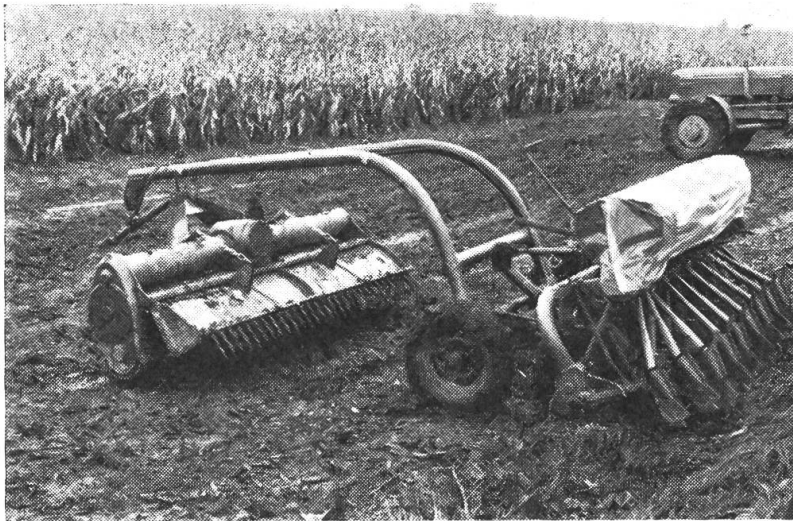
Abb. 2: Über einen Zusatzrahmen wird an eine Anbaufräse eine serienmässige Drillmaschine angehängt.
