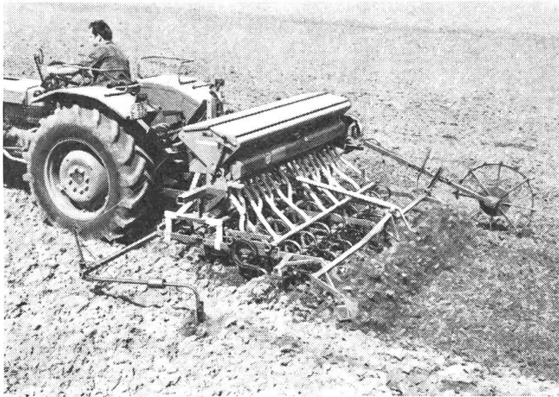
Abb. 9: Auf einer Federzahnegge und Krümmer wird der Säkasten der Fräs-Drill-Kombination (vorwiegend zur Einsaat von Sommergetreide im Frühjahr) weiter verwendet. Es entsteht eine schlagkräftige Frühjahrskombination.
