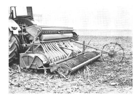
Abb. 5: Fräs-Drill-Kombination im Einsatz auf überwintertem Maisstroh zur Sommerweizeneinsaat.
