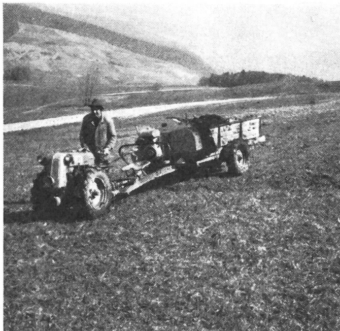
Abb. 2: Der kleine Aufbauzetter auf einer schwachen Zugkraft ist schon bei geringen Feldentfernungen ein teures Verfahren.
