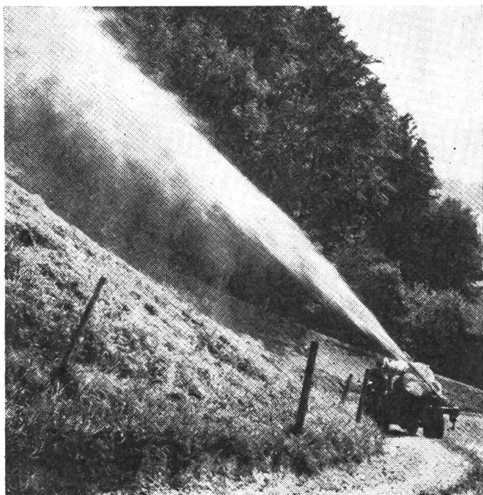
Abb. 3: Der Einsatz des Fasses ist in Hangbetrieben meistens nur dann möglich, wenn man die Feldwege nicht verlassen muss. Dazu bietet das Pumpfass gute Voraussetzungen.
