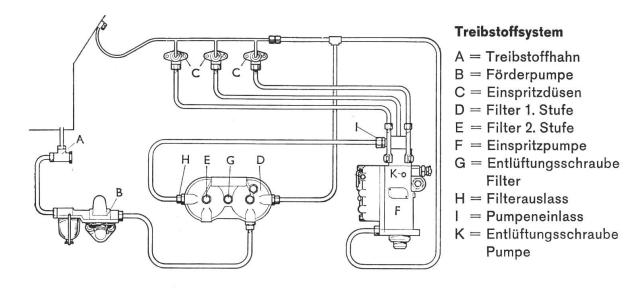
Nach jedem Filterwechsel muss die Einspritzanlage entlüftet werden Ebenso nach dem Leerfahren des Treibstofftankes.
