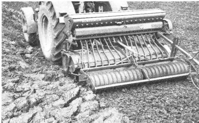
Abb. 7: Selbst bei gepflügtem Acker kann mit der Fräs-Drill-Kombination in einer Ueberfahrt die Bodenbearbeitung, die Saat und das Andrücken der Saat, erledigt werden.
