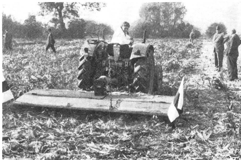
Abb. 2: Nach dem Mähdrusch wird das Maisstroh zerschlagen, damit es besser eingepflügt wer- den kann.
