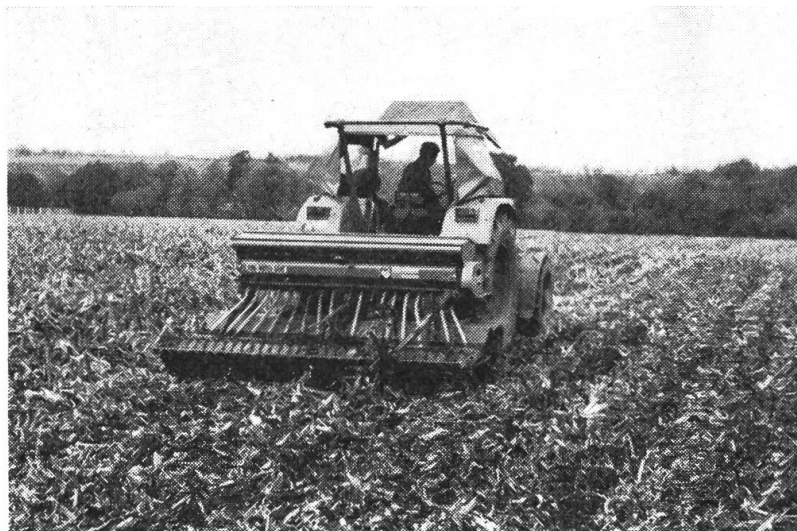
Abb. 6: In einem Arbeitsgang wird das Maisstroh in die obere Bodenschicht eingearbeitet und die Saat eingebracht.
