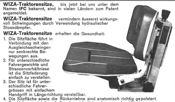
Der Ueberzug ist dauerhaft, gut verarbeitet und regenundurchlässig. 5. Die Rückenlehne mit überhöhter Polsterung ist höhenverstellbar.
