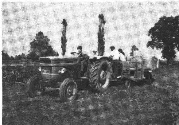
Wie im Bild ersichtlich ist, wird der neue Sack-Sammelwagen auf der linken Seite des «Samros» angebaut und mitgezogen. In einer Minute ist der Wagen an- oder abgebaut. An zwei Stellen sind der Samro und der Wagen miteinander verbunden und zwar mit Haken zum einhängen.
