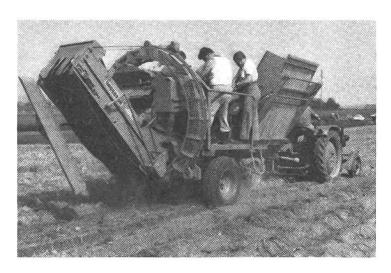
Kartoffel-Vollernter «Wisent RB» mit Siebkette, die durch Klutenzerreiber und Bremsmatten unterstützt werden kann.
