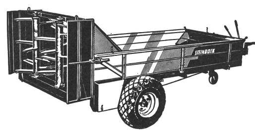
Mit zwei stehenden Streuwalzen Brückengrösse 125 x 300 cm Robustes Oelbadgetriebe mit gehärteten Stahlzahnrädern Konstruktion wie bei den grossen Modellen.
