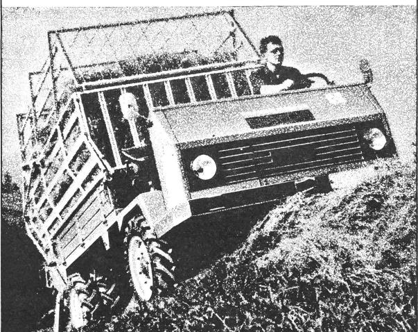
Wir bauen Transporter mit 25 und 40 PS Leistung. Abgestimmt auf Ihre Anforderungen. Das schätzt man. Und vieles andere mehr: Rasches, exaktes Laden am Steilhang. Werkzeuglos — in 10 Minuten — erfolgt der Umbau Ladewagen — Mistzetter. Güllefaß, Seilwinde, Kreiselheuer — zapfwellenbetrieben — sichern optimalen Einsatz. 8 Vor- u. 8 Rückwärtsgänge, Portalachsen, Allradantrieb, hydr. Vierradbremse (25 PS), hydr. 2-Kreis-Vierradbremse (40 PS). Zwillingspneus hinten.
