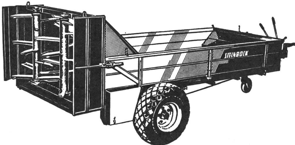
Mit zwei stehenden Streuwälzen Brücken- grösse 125 x 300 cm Robustes Oelbad- getriebe mit gehärteten Stahl- zahnrädern Konstruktion wie bei den grossen Modellen.
