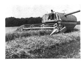
Claas geht neue Wege im Mähdrescherbau. Runde, wuchtige Formen bestimmen diese Versuchsmaschine eines neuen Grossmähdreschers. Die Schneidewerkbreite dieses in der ersten Erprobung befindlichen Typs beträgt 5,10 m.
