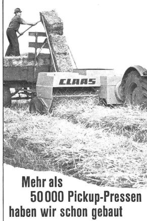
Bereits 1937 begannen wir mit dem Serienbau von Pickup-Pressen. Als erste in Europa. In dieser jahrzehntelangen Erfahrung liegt der Grund für die hohe Qualität und die tadellose Arbeitsweise der CLAAS-Pickup-Pressen. Sie sammeln, pressen, binden und laden in einem Arbeitsgang. Die exakt geformten Ballen sind zweimal gebunden. Die Bindesicherheit der weltberühmten CLAAS-Knoter ist sprichwört-
