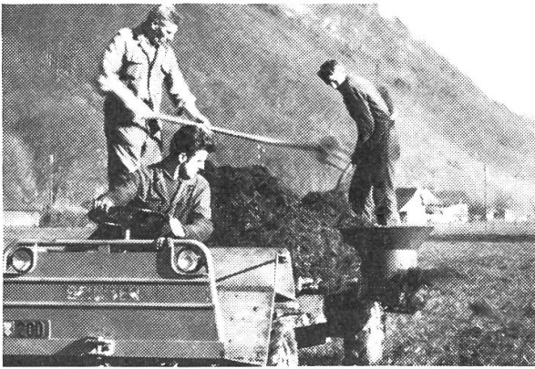
Abb. 8: Dieser Stallmiststreuapparat ist zwar noch etwas arbeitsaufwendig aber verhältnismässig billig und erfordert eine geringe Antriebsleistung. Er wird daher auch gut verkauft.
