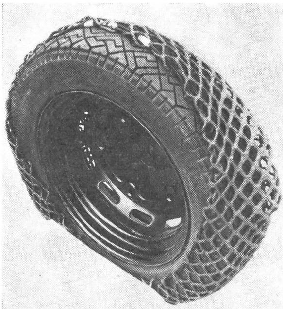
Auf jeden normalen Autoreifen kann man mühelos den neuen Reifengleitschutz «Bergfreund» auflegen. Es handelt sich hier um eine synthetische Netzmatte, die mit einem Nocken-Kautschukmantel umgeben ist. In die beiden Seiten des Netzes ist ein Gummiseil eingelegt, welches das Netz auf der Bereifung festhält. Das Auflegen am hochgebockten Rad ist schnell und fast mühelos durchzuführen. Das Netz wird einfach von aussen über den Reifen geschoben, nachdem man es unten eingelegt hat.
