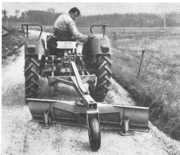
... ist das WH 10 - SGV-Planierschild. Es ist nicht nur für die Planierung von Wegen, für die Befreiung von Schnee, sondern auch für die Säuberung der Offenställe und zum Holztransport beispielsweise über Fahrrinnen im Frost bestens geeignet.
