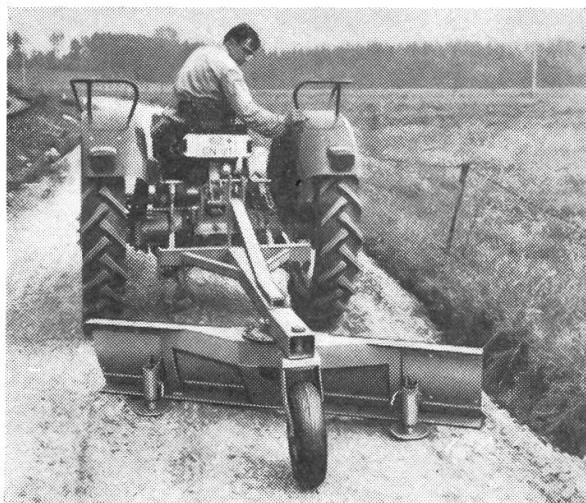
... ist das WH 10 - SGV-Planierschild. Es ist nicht nur für die Planierung von Wegen, für die Befreiung von Schnee, sondern auch für die Säuberung der Offenställe und zum Holztransport beispielsweise über Fahrinnen im Frost bestens geeignet.
