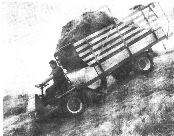
Abb. 4: Hier nimmt das Ladeaggregat sehr wenig Raum ein und die Sicht auf die Pick-up dürfte tatsächlich gegeben sein.
