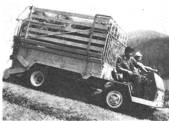
Abb. 6: Der relativ geringe Abstand von Hinterachse zur Pick-up erhöht die Fahrsicherheit und das Steigvermögen durch günstige Gewichtsverteilung.
