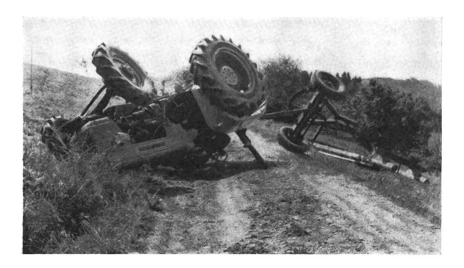
Das Befahren von aufgeweichtem Gelände hat dem Lenker des oben abgebildeten Allrad-Traktors mit unbeladenem Anhänger das Leben gekostet. Das Fahrzeug geriet auf einer Bodenwelle mit ca. 35 % Steigung ins Gleiten und überschlug sich beim Einmünden in die Bergstrasse.
