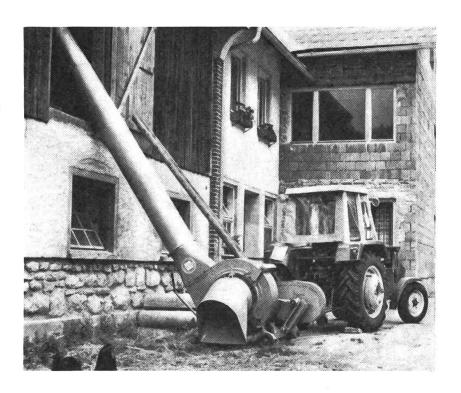
Als Zusatzeinrichtung zu den Fördergebläsen gibt es Schneideinrichtungen, mit denen trockenes und grünes Material zerkleinert werden kann. Ein derartiges Schneidwerk besteht aus einem zwei- bis vierarmigen Schneidstern, der am Messerrad befestigt wird und einer Anzahl von Gegenschneiden, welche am Umfang der Ansaugöffnung montiert werden. Der auf diese Weise erzielte Schnitt ist in der Länge unregelmässig, grüne und
