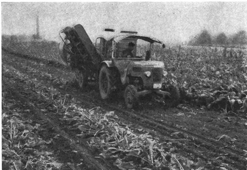
Der einreihige Bunkerköpfroder, in Einmannarbeit eingesetzt, ist nach wie vor die schlagkräftigste Maschine in der Zuckerrübenernte. Das Blatt kann in Längs- oder Querschwaden abgeladen oder auf viehlosen Betrieben gehäckstet auf den Acker gestreut werden.
