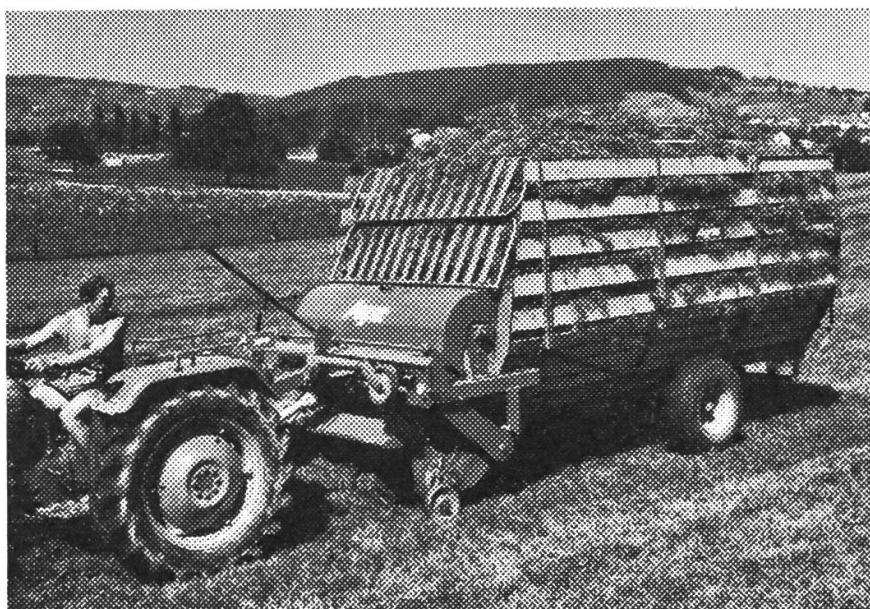
gewonnen. Die hydraulische Vierrad-Lenkung macht dieses Fahrzeug zu einem unvorstellbar wendigen Helfer. Vom Besitzer eines solchen Fahrzeuges wird vor allem die Uebersichtlichkeit der Bedienungshebel als besonderer Vorteil erwähnt. Die direkte Futteraufnahme vor den Vorder-
