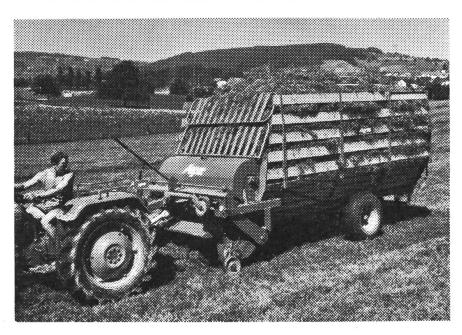
gewonnen. Die hydraulische Vierrad-Lenkung macht dieses Fahrzeug zu einem unvorstellbar wendigen Helfer. Vom Besitzer eines solchen Fahrzeuges wird vor allem die Uebersichtlichkeit der Bedienungshebel als besonderer Vorteil erwähnt. Die direkte Futteraufnahme vor den VorderDer Ladewagen bildet nach wie vor die grosse Spezialität der AGRAR. Dank dem schonenden Aufladen von heiklen Futterarten durch das Elevatorsystem ist der AGRAR-Ladewagen auch heute noch zur begehrtesten Maschine geworden.
