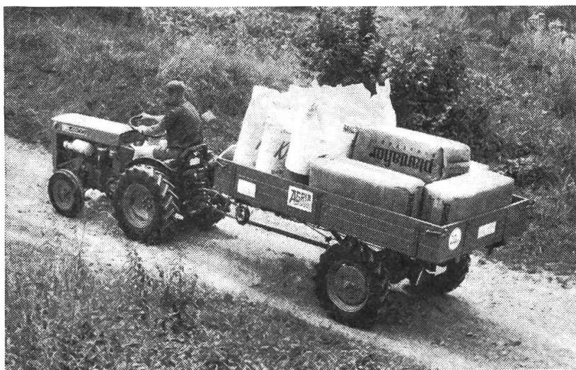
Abb. 3: Agria 4-Rad-Kleintraktor, Typ 4800, mit 12/14 PS- Diesel-Motor. Der Traktor ist 225 cm lang, 110 cm hoch und wiegt 550 kg. (Werkbild Agria)
