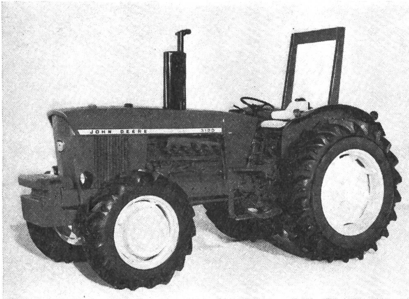
Abb. 2: Traktor John Deere 3120 mit 81 PS und hydrosta- tischem Frontantrieb. Der Traktor wiegt 3500 kg und misst 238 cm in der Höhe, 243 cm in der Breite und 406 cm in der Länge. (Werkbild John Deere)
