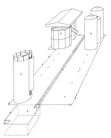
Abb. 2: Siloplatte für Gärfutter-Hochsilos
