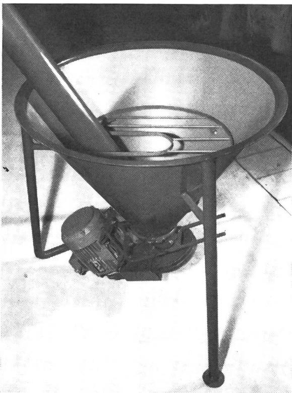
Ueberall dort, wo mehrere Getreide- oder Düngersilos von einem Punkt aus gefüllt werden sollen, bietet sich diese dreh- und kippbare Schnecke mit Einfülltrichter an. Der Antriebsmotor der Schnecke befindet sich aus Gründen der Schwerpunktverlagerung unten an der Schnecke. Das Fördergut – Getreide oder Mineraldünger – wird in den 0,80 m oder 1,20 m breiten Einlauftrichter gefüllt und von der kippbaren Schnecke in die gewünschte Richtung transportiert. Die Schnecke gibt es in
