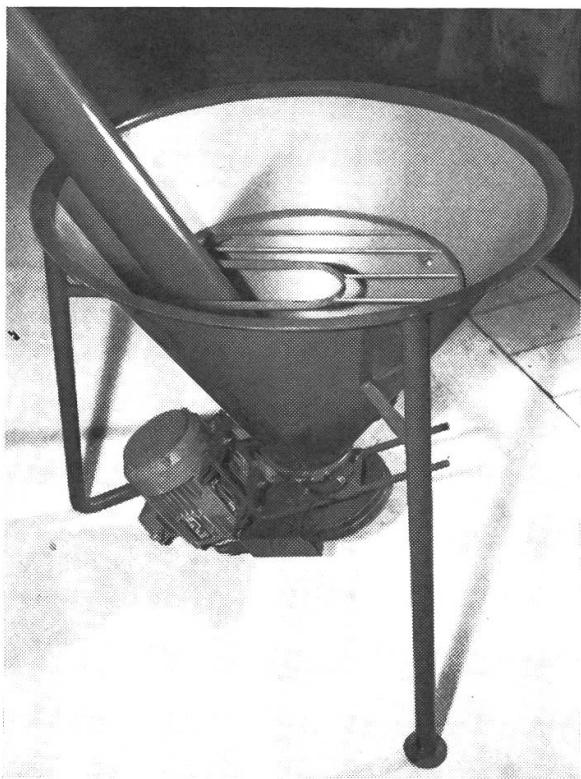
Ueberall dort, wo mehrere Getreide- oder Düngersilos von einem Punkt aus befüllt werden sollen, bietet sich diese dreh- und kippbare Schnecke mit Einfülltrichter an. Der Antriebsmotor der Schnecke befindet sich aus Gründen der Schwerpunktverlagerung unten an der Schnecke. Das Fördergut – Getreide oder Mineraldünger – wird in den 0,80 m oder 1,20 m breiten Einlauftrichter gefüllt und von der kippbaren Schnecke in die gewünschte Richtung transportiert. Die Schnecke gibt es in
