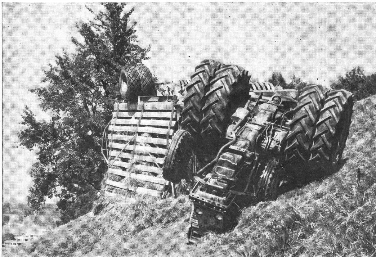
In diesem Fall blieb der Führer wie durch ein Wunder unversehrt. Zuerst stürzte der doppelbereifte Anhänger, dann der Traktor. Bei **drehbarem Deichselkopf oder Anhängemaul** wäre der Traktor wahrscheinlich stehen geblieben.
