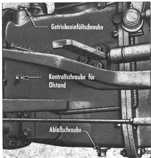
**Getriebeöl-Einfüll-, Kontroll- und -Entleerungsöffnungen**
