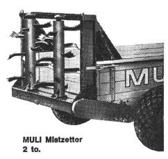
MULI-Mistzetter — ein Begriff: Feinstreuwerk, 6 m Arbeitsbreite, Streumenge und Streubreite vom Fahrersitz aus einstellbar, Pritschenhöhe 64 cm — daher leicht zu beladen. — Mit Schnellverschluß abnehmbares Streuwerk, serienmäßig mit Rückwand ausgestattet — daher als Transportwagen mit Kratzboden einzusetzen.
