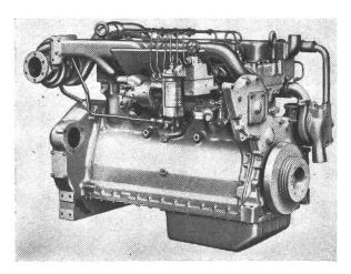
Wie die Industrial Division von Caterpillar bekanntgab, soll eine neue Reihe von Hochleistungs-Dieselmotoren mit 121 mm Bohrung und 152 mm Hub für industrielle Zwecke, Schiffsantriebe und Stromaggregate eingeführt werden.
