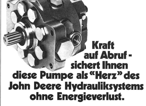
Auf einem Traktor ist Hydraulik nichts Aussergewöhnliches. Aber auf einem JOHN DEERE arbeitet sie in geschlossenem Kreislauf (closed Center): Eine Pumpe mit radialwirkenden Kolben, konstantem Druck und veränderlicher Fördermenge bildet das wahre «Herz» der Anlage und erzeugt die erforderliche Leistung — bei der kleinsten Beanspruchung.
