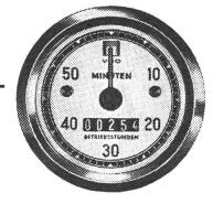
Erfassen die effektive Laufzeit des Motors in Stunden und Minuten.
