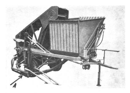
portiert. Nach dem Köpfen werden die Rüben mit einem Förderband in den Kipp- oder Kratzbodenbunker gebracht. Die beschriebene Arbeitsweise wird auch bei Vorratsrodern, die ebenfalls zahlreich ausgestellt wurden, praktiziert. Die Rüben und Blätter werden hier in getrennten Reihen abgelegt. Die Verkaufspreise betragen ca. 2700.— bis 7000.— DM für einen Vorratsroder bzw. Vollernter (Lengerich, Emsbüren). (Fortsetzung folgt)
