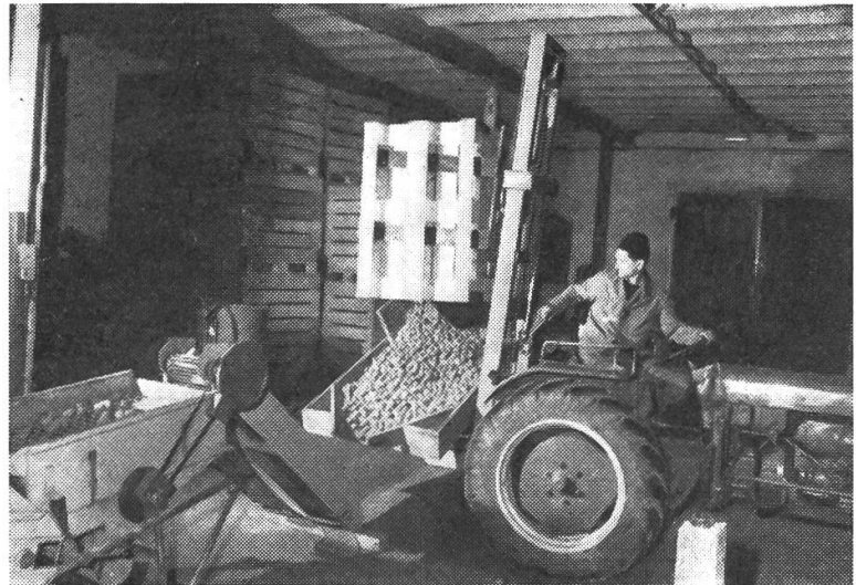
Abb.5 + 6: Norm-Paloxe (Länge 120 cm, Breite 80 cm, Höhe 115 cm, Inhalt 0,85 m 3 ). In der Landwirtschaft lässt sich der Umschlag in Paloxen mit Hilfe der Anbaustapler leicht durchführen. Zum Entleeren werden die Paloxen gekippt.
