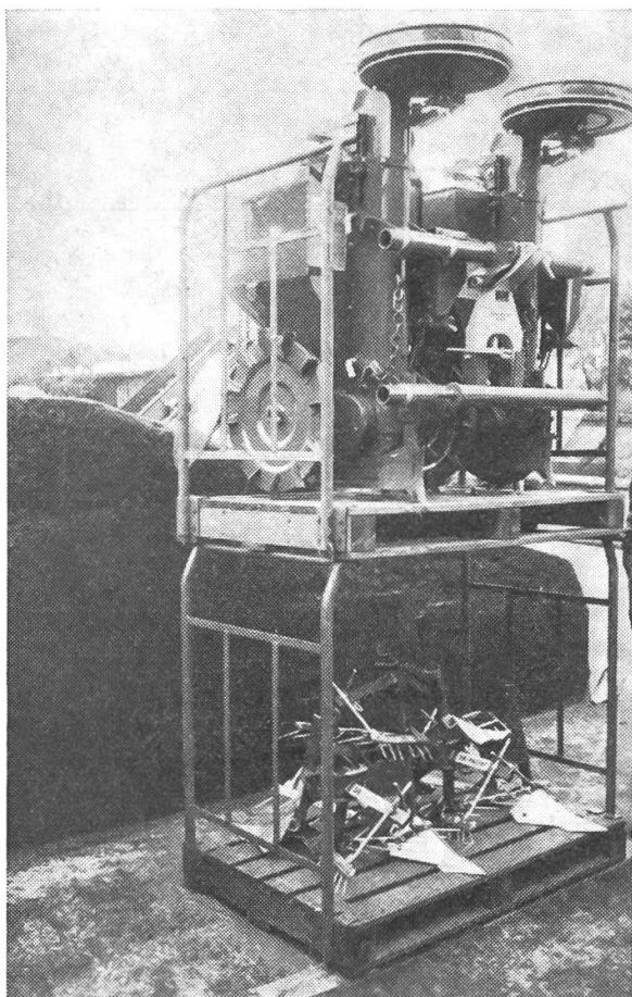
zeigt, die Geräte aufnehmen und mit dem Frontlader aufeinandergestapelt werden können. Auf diese Weise wird der oftmals ungenutzte Höhenraum nutzbringend ausgefüllt und man spart die Anlage von weiterem, kostspieligem Maschinenraum.
