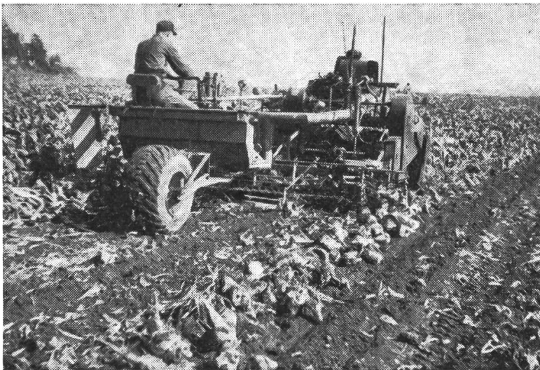
Rübenerntemaschine als Selbst-Fahrer-A 500 köpft und rodet gleichzeitig 6 Reihen und legt Blätter in Längsschwaden von jeweils 2 \times 6 = 12 Reihen ab. Mit einem Ladegerät werden dann die Rüben aus dem 12reihigen Schwad aufgenommen, nachgereinigt und auf nebenher fahrende Wagen geladen.
