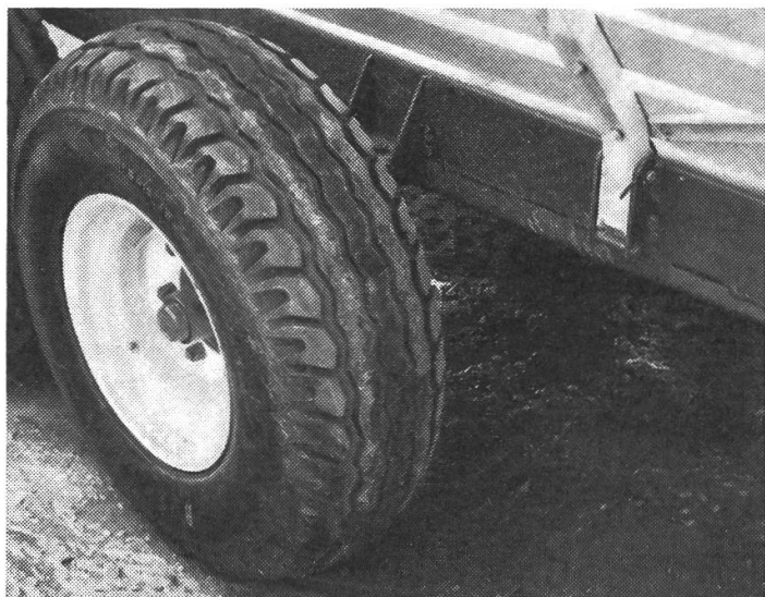
Abb. 1: Ackerwagenprofil (AW) mit Zick-zack-Längsrillen.
