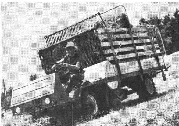
Zusammen mit seinen interessanten Zusatzgeräten kann der Bucher-Transporterladewagen TRL 2600 das ganze Jahr über eingesetzt werden. Wichtig ist das typisch schweizerische Konstruktionskonzept, welches aussergewöhnlich kurze Umbauzeiten von der einen auf die andere Arbeitsweise ermöglicht und mit welchem wir dem Hang- und Bergbetrieb nicht nur eine ideale Arbeitsmaschine, sondern auch ein vollwertiges Transportfahrzeug anbieten können.
