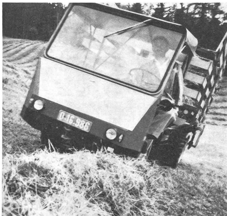
Selbstfahrladewagen mit Fördereinrichtung hinter dem Fahrzeug überfahren bei Schichtenlinienarbeit, wegen der Abdrift, mit dem untern Vorderrad die Schwad auf **deren ganzen Länge**. Die Bröckelverluste sind dabei bedeutend und unvermeidlich.
