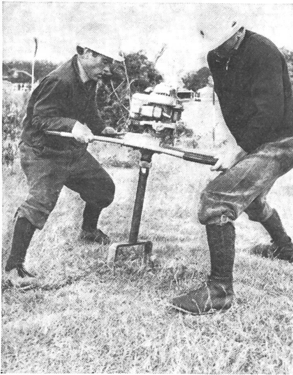
Abb. 3: Mit dem Motorsägemotor bzw. Krümmer kann man Pflanz- und Pfahllöcher bohren. Die Kosten je Pflanzloch sollen ca. 10 Rp. betragen.
