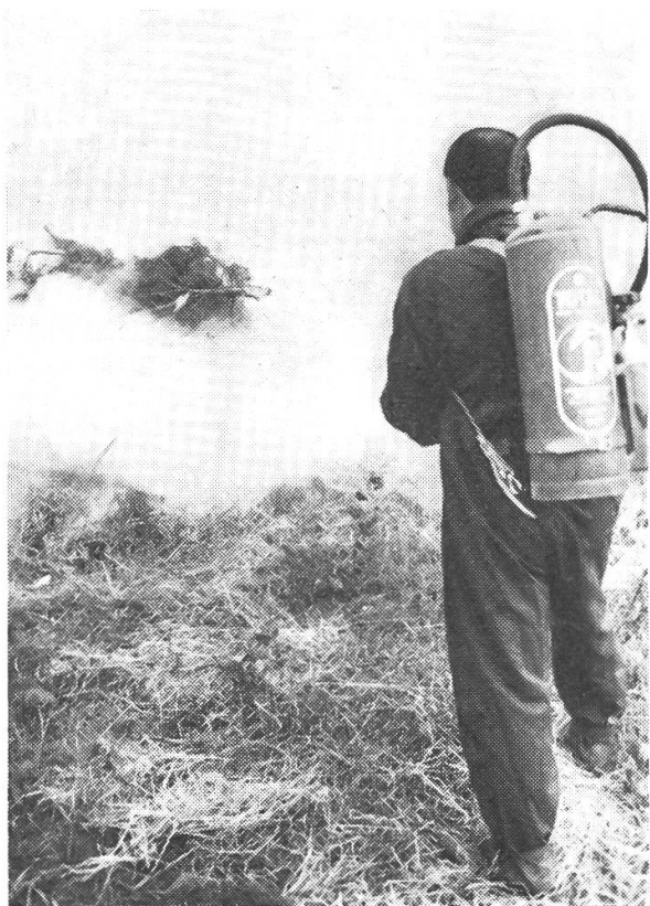
Abb. 8: Rasch handeln, das ist beim Entstehen eines Waldbrandes oberstes Gebot. Diese Trockenschaumlöcher können blitzartig ein entstehendes Feuer löschen.
