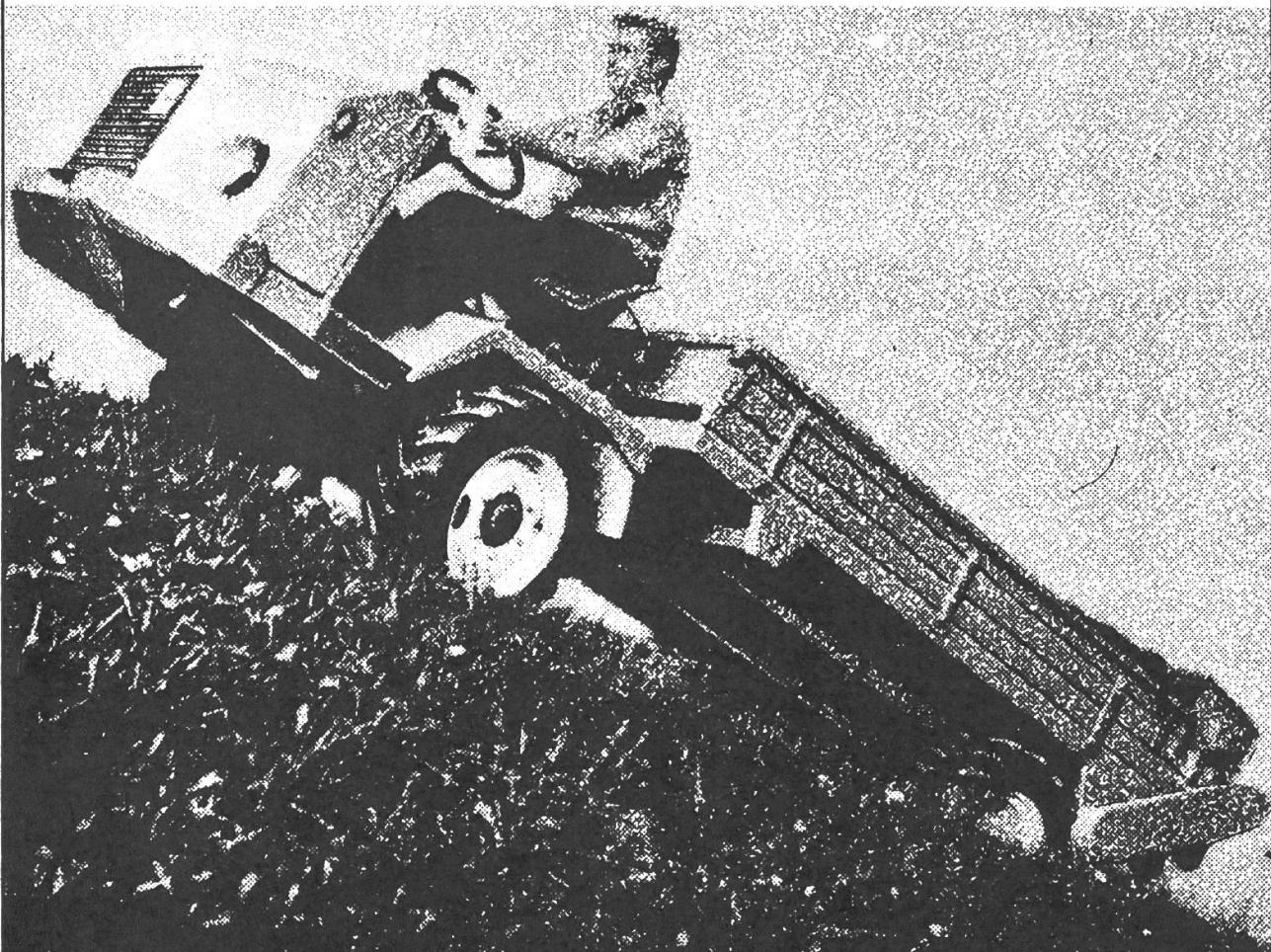
Wir bauen Universal-Traktoren mit 25 und 40 PS Leistung. Abgestimmt auf Ihre Anforderungen. Das schätzt man. Und vieles andere mehr: Rasesches, exaktes Laden am Steilhang. Werkzeuglos — in 10 Minuten — erfolgt der Umbau Lädewagen — Mistzetter, Güllefass, Seilwinde, Kreiselheuer — zapfwellenbetrieben — sichern optimalen Einsatz. 8 Vor- und 8 Rückwärtsgänge, Portalachsen, Allradantrieb, hydr. Vierradbremse (25 PS), hydr. 2-Kreis-Vierradbremse (40 PS). Zwillingspneus hinten.
