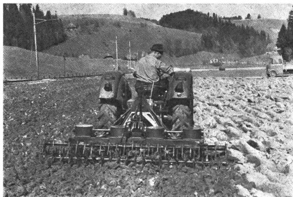
Aufreissen abgeernteter Stoppelfelder. Unkrautwurzeln werden nicht etwa zerschnitten sondern an die Ackeroberfläche befördert. — Das patentierte Gerät hat eine Arbeitsbreite von 2,3 m, ein Gewicht von ca. 390 kg und benötigt je nach Arbeitstiefe und Bodenart ab 35 PS starke Traktoren.
