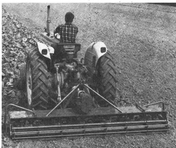
Wenn man Zinken abmontiert, kann die Arbeitsbreite der Egge der Breite einer zweiten Maschine angepasst werden. Auch eine Reihenbearbeitung ermöglicht sich dadurch. Die Arbeitsbreite der Maschine ist 3 Meter.
