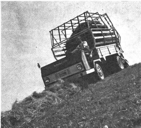
Die breite Bauweise des Reform Muli 25 mit Portalachsen vorne und hinten von 42 cm Bodenfreiheit bürgen für grösste Sicherheit und exakte Arbeitsweise. Der kräftige 30 PS-Deutz-Diesel-Motor und das fein abgestufte Wendegetriebe mit 8 Vorwärts- und 8 Rückwärts-Gängen, verleiht dem Reform Muli 25 hervorragende Eigenschaften im schwierigen Gelände.
