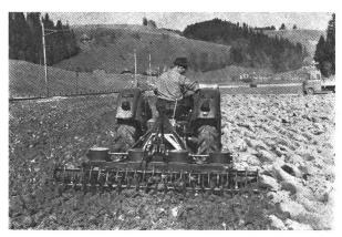
Aufreissen abgeernteter Stoppelfelder. Unkrautwurzeln werden nicht etwa zerschnitten sondern an die Ackeroberfläche befördert. — Das patentierte Gerät hat eine Arbeitsbreite von 2,3 m, ein Gewicht von ca. 390 kg und benötigt je nach Arbeitstiefe und Bodenart ab 35 PS starke Traktoren.
