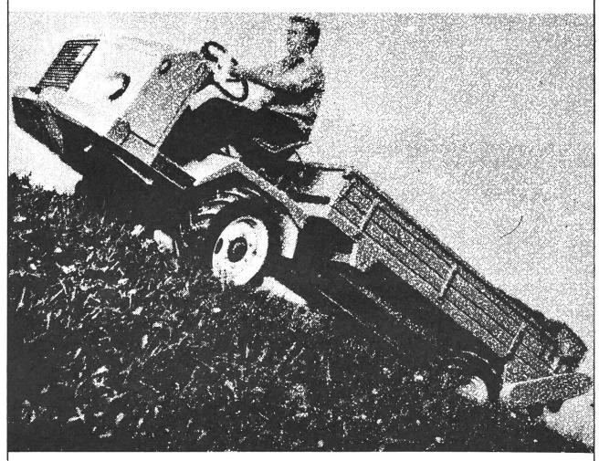
Wir bauen Universal-Traktoren mit 25 und 40 PS Leistung. Abgestimmt auf Ihre Anforderungen. Das schätzt man. Und vieles andere mehr: Rasches, exaktes Laden am Steilhang. Werkzeuglos — in 10 Minuten — erfolgt der Umbau Ladewagen — Mistzetter. Güllefass, Seilwinde, Kreiselheuer — zapfwellenbetrieben — sichern optimalen Einsatz. 8 Vor- und 8 Rückwärtsgänge, Portalachsen, Allradantrieb, hydr. Vierradbremse (25 PS), hydr. 2-Kreis-Vierradbremse (40 PS). Zwillingspneus hinten.
