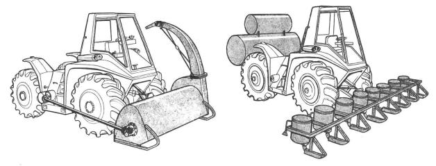
Amerikanischer «Zukunfts-Traktor» mit hydraulischen Hebevorrichtungen vorn und hinten, mehreren Zapfwellenanschlüssen und mit klimatisierter Kabine.
