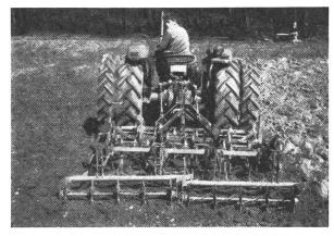
Abb. 3 und 4: Je nach Bodenart und -beschaffenheit hat sich zur Saatbettvorbereitung eine Zinkenegge oder ein Vibrierzinken-Kultivator mit einem Krümler gut bewährt. Auch für diese Arbeit ist die Doppelbereifung zu empfehlen.
