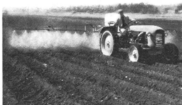
Abb. 6 und 7: Die Mittel zur Unkrautbekämpfung und gegen Krautfäule sind wirksamer, wenn sie bei Niederdruck und stärker konzentriert ausgebracht werden (Abb. 7).
