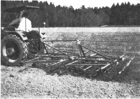
Abb. 3 und 4: Je nach Bodenart und -beschaffenheit hat sich zur Saatbettvorbereitung eine Zinkenegge oder ein Vibrierzinken-Kultivator mit einem Krümmer gut bewährt. Auch für diese Arbeit ist die Doppelbereifung zu empfehlen.
